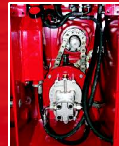
Pogon pumpe izveden sa zupčastim multiplikatorom
