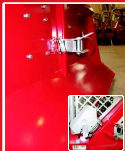
Sklop - ugrađen serijski odvojiv pomoću vijaka i zaštita vijaka
