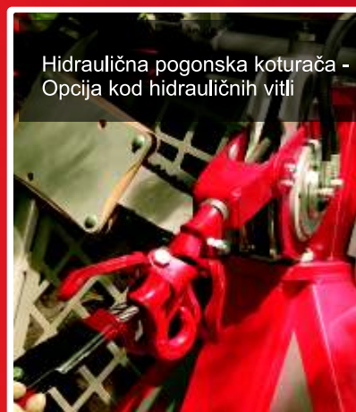
Pomoć pri izvlačenju sajle iz bubnja - omogućava jednakomjerno namatanje sajle na bubanj pri izvlačenju i uvlačenju
