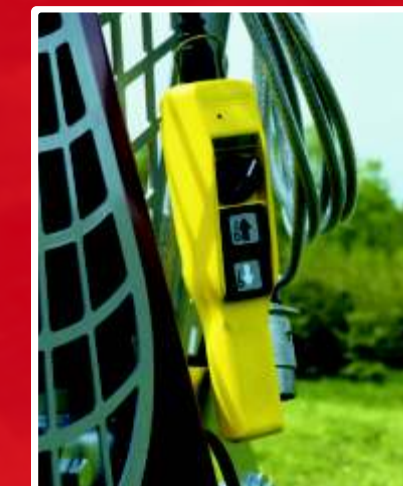
S upravljačkom konzolom (pri AHK vitlima)
