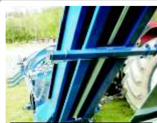
Transporter (4m)-serijski: sa dvostepenim teleskopom i sa automatskim hidrauličkim napinjačem trake. Brzina trake je nameštena bez stepena regulacije.
