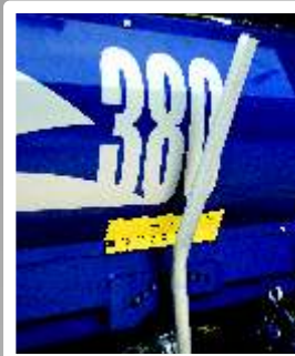
Pomoću ručice podešavamo visinu cepajućeg noža s obzirom na debljinu trupaca.
