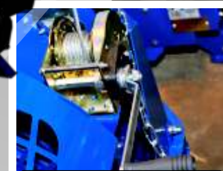
Vitlo za podizanje i spuštanje transportera
